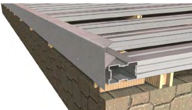
35. Inicio de instalación con perfil F
