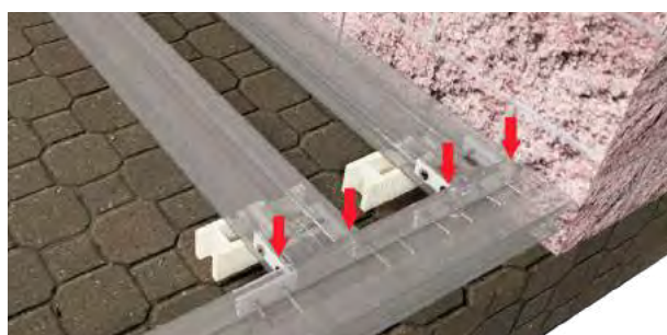
31. Vista de las escuadras perimetrales fijada al rastrel longitudinal perimetral.
