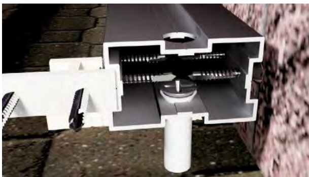
29. Agujero en rastrel de aluminio y tornillo taco.
