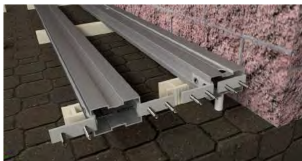
30. Vista seccionada de rastrel fijado con tornillo de golpeo al suelo y las escuadras de aluminio de rastreles perimetrales.
