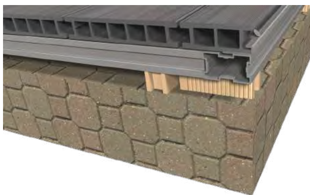
51. Detalle perfil de inicio atornillado al rastrel.
