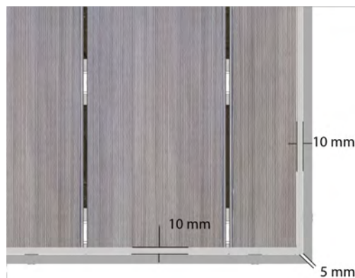
56. Atornillado de tapeta en rastrel de aluminio.
