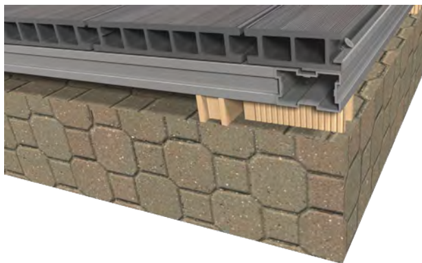
51. Detalle perfil de inicio atornillado al rastrel.
