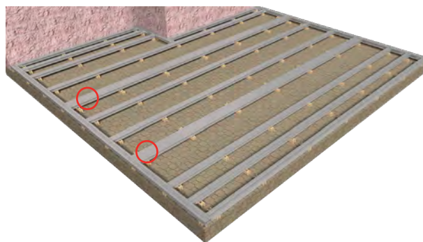
16. Estructura de rastreles para encuentro entre testasy intermedio.
