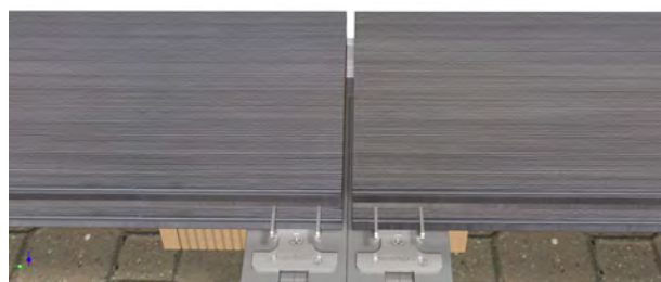
19. Doble rastrelado entre testasy con un clip para cada lama.
