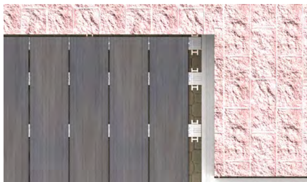
45. Hueco para la colocación lama. Detalle.
