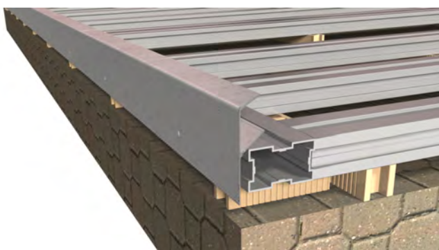
35. Inicio de instalación con perfil F
