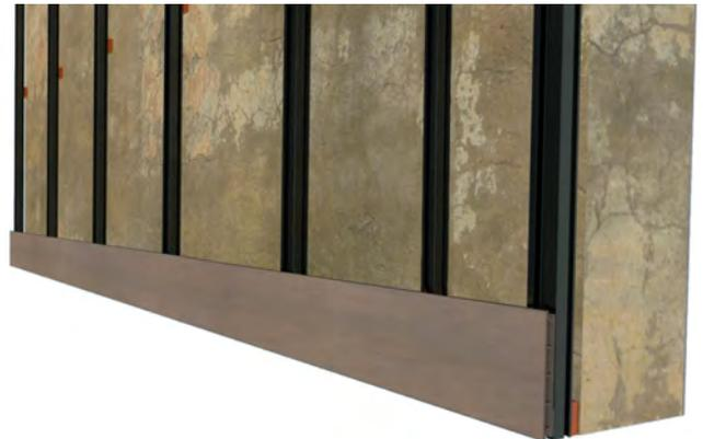
La parte superior de la tabla, la sujetamos con el clip de montaje rápido Mont Blanc. Este clip se inserta en el canal del rastrel con un simple giro y lo encajamos en ala de sujeción del perfil Mont Blanc hasta escuchar "clic". Aunque el clip va provisto de agujero para alojar un tornillo, de momento, no será necesario atornillar, lo que reduce considerablemente el tiempo de montaje.
