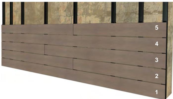
El tornillo que emplearemos será DIN 7504 P A2 4,2 x 25 mm, y se atornillarán cada uno de los clips colocados sobre la quinta fila de perfil Mont Blanc. Solo será necesario atornillar los clips al rastrel cada 5 filas de perfil instalado. *p.e. en una instalación de 23 filas de perfil Mont Blanc, solo será necesario fijar el clip al rastrel en 4 filas (filas 5, 10, 15 y 20).*
