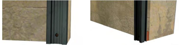
Los rastreles de la instalación, se fijan al sustrato mediante tornillo-taco de golpeo de al menos 6 mm. Estos tornillos deben ser de acero inoxidable AISI 304, y AISI 316 si se la instalación se realizara en ambientes marinos.
