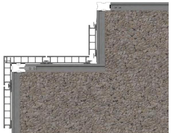
Fijado el manperlán, se colocaría la siguiente tabla para, en este ejemplo, cubrir por completo la huella del primer peldaño. La fijación de esta tabla se realiza también mediante la utilización del clip Tarimatec.
