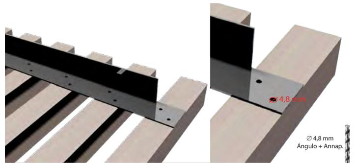
Del mismo modo que en lo anteriores, se utiliza remache de  $\varnothing 4,8 \times 16$  mm de longitud, pero en este caso con una cabeza de diámetro 10 mm será suficiente.
