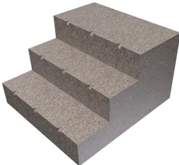
Se coloca el primer rastrel en la contrahuella del primer peldaño. la separación entre rastreles no superior a 350 mm.
