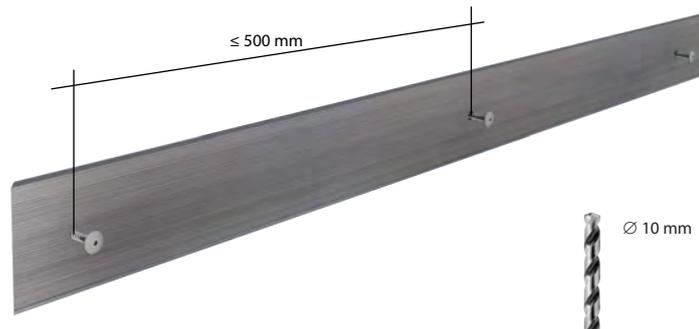
Se puede realizar un acabado con tapeta, que será como el que se muestra en la imagen. Para evitar el cierre de la junta de dilatación, en las piezas perimetrales, el tornillo 7505A que se pone en cada perfil para evitar el desplazamiento de las tablas, se podrá en el clip más externo como muestra en la imagen. La junta de dilatación será como mínimo de 5 mm.
