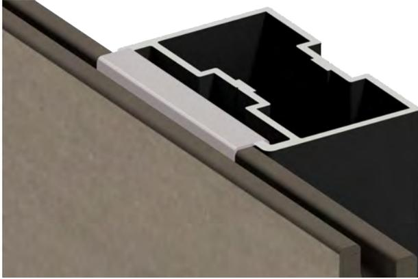
También es posible realizar la junta a inglete teniendo a ambos lados perfil Mont Blanc. Del mismo modo, la fijación de los perfiles perimetrales con el tornillo 7505A, se hará en el clip más externo. La junta de dilatación entre del inglete será de igual modo de al menos 5 mm.
