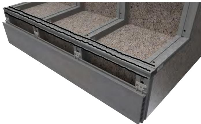
Aplicado el adhesivo, se procede a la colocación del mamperlán, el cual, se fija tanto en la contrahuella como en la cara de la huella del primer peldaño, con el clip Tarimatec, como se muestra en la siguiente imagen:
