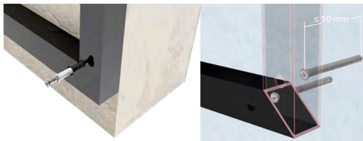
Se colocan los perfiles hasta realizar el marco exterior del panel a instalar, realizando la fijación como se ha indicado.
