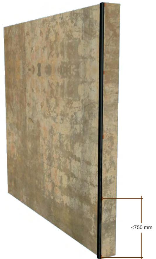
Tal como se puede apreciar en la imagen anterior, un rastrel de 3m de longitud, debería estar fijado por al menos 5 puntos equidistantes.
