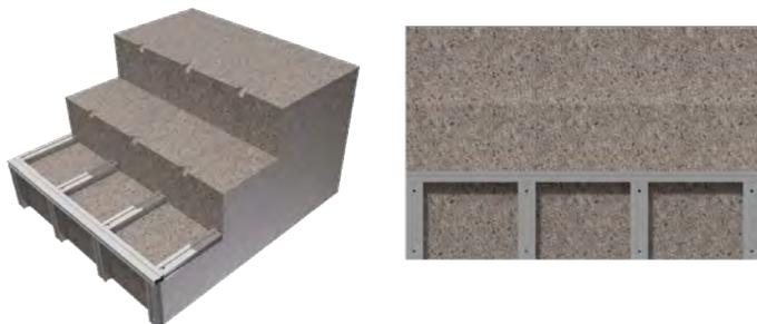
Se atornillan los rastreles de la huella del primer peldaño utilizando el tornillo de golpeo anteriormente visto y se coloca el rastrel del borde del peldaño que va sujeto a los rastreles colocados en la huella mediante escuadras a ambos lados del rastrel.
