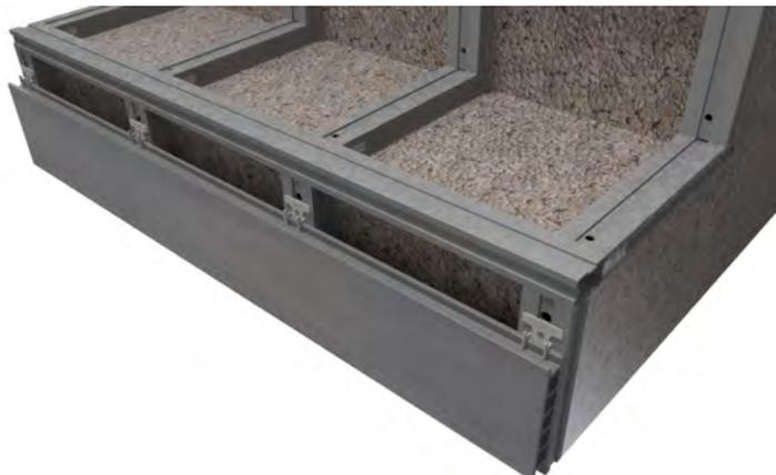
Esta lama de tarima es sujeta por su aleta superior con clips Tarimatec. Tanto el clip de inicio como el clip Tarimatec, se fija al rastrel de aluminio con el tornillo 7504P 4,2 x 25 mm. Colocada la primera lama, vemos que el espacio en la contrahuella es insuficiente para el alojamiento de una lama completa, por lo que en este punto, debemos realizar la mecanización y ensamblaje del mamperlán.
