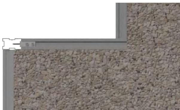
Se instalan del mismo modo que en la primera contrahuella, los rastreles de la segunda, apoyando, como se aprecia en la imagen anterior y la siguiente, sobre los rastreles de la huella del primer peldaño.
