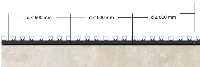
La fijación de las aletas a los tubos cuadrad horizontales se realiza mediante remaches de 4,8 x 16 mm. Éstos, no tendrán una separación superior a los 600 mm. La distancia entre el extremo del perfil y el suelo debe ser de al menos 10 mm para evitar choques por dilataciones y contracciones.
