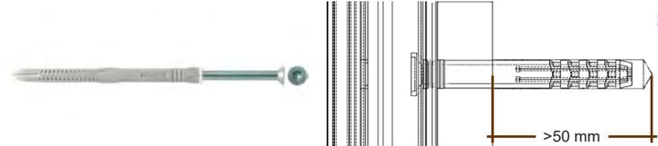
El tornillo de golpeo debe entrar, al menos, 50 mm en el sustrato, de manera que cuando el taco realice la expansión, se pueda garantizar una correcta sujeción. La separación máxima de los tornillos que sujetan el rastrel a la pared, será como máximo de 750 mm.
