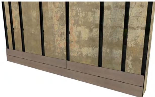
En la segunda fila de perfil Mont Blanc instalada, se aprecia que hay dos tablas. Estas dos tablas comparten el mismo clip, siendo la separación entre ellas de **6 mm** para tablas de hasta **2,5 m**.
