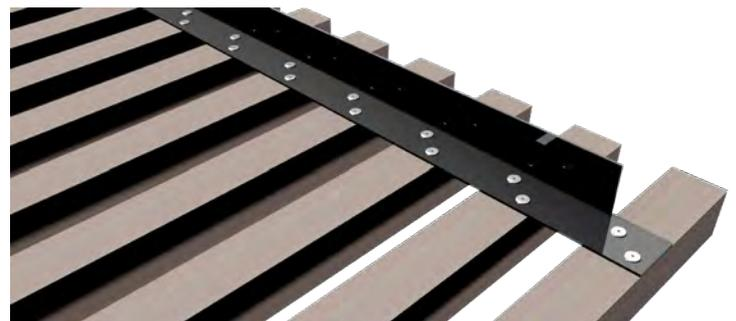
Realizados los agujeros, se fija cada uno de los perfiles Annapurna al ángulo mediante remaches. Los remaches deben ser de  $\varnothing 4,8 \times 16$  mm de longitud. La cabeza del remache debe tener un diámetro mínimo de 14 mm. Esto es para facilitar las posibles dilataciones y contracciones que pueda tener el perfil por los cambios de temperatura y humedad.
