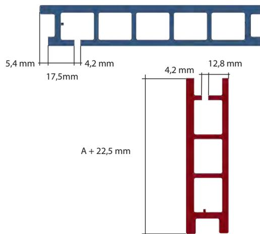
Realizado el mecanizado, se realiza el ensamblaje, deslizando por las dos ranuras abiertas las piezas entre sí. Se puede utilizar adhesivo MS para consolidar la unión.
