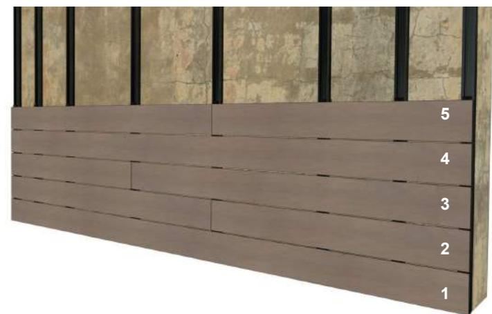
El tornillo que emplearemos será DIN 7504 P A2 4,2 x 25 mm, y se atornillarán cada uno de los clips colocados sobre la quinta fila de perfil Mont Blanc. Solo será necesario atornillar los clips al rastrel cada 5 filas de perfil instalado. *p.e. en una instalación de 23 filas de perfil Mont Blanc, solo será necesario fijar el clip al rastrel en 4 filas (filas 5, 10, 5 y 20).*
