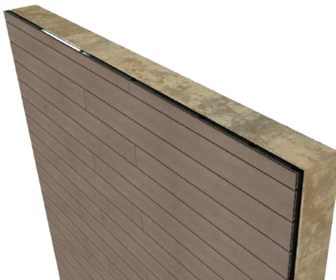
La última fila de perfil Mont Blanc cortado, está fijada al rastrel por su parte inferior mediante el clip Mont Blanc. La parte superior del perfil (que es la cortada) se puede fijar utilizando el perfil de inicio. Para ello cortaremos el perfil de inicio en trozos de 40 mm, y cortaremos tantos como rastreles verticales colocados haya en nuestra instalación.
