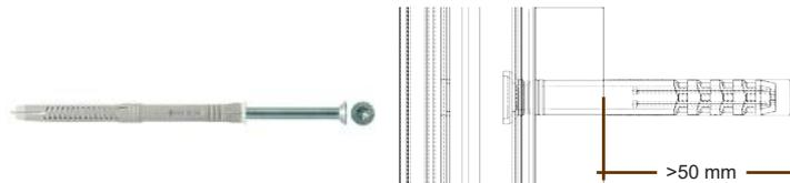
El tornillo de golpeo debe entrar, al menos, 50 mm en el sustrato, de manera que cuando el taco realice la expansión, se pueda garantizar una correcta sujeción. La separación máxima de los tornillos que sujetan el rastrel a la pared, será como máximo de 750 mm.
