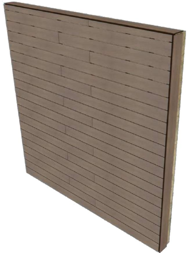
Se puede realizar un acabado a inglete, que será como el que se muestra en la imagen. Para evitar el cierre del inglete, en las piezas perimetrales el tornillo 7505A que se pone en cada perfil para evitar el desplazamiento de las tablas, se podrá en el clip más externo como muestra en la imagen. La junta de separación entre testas será como mínimo de 5 mm.
