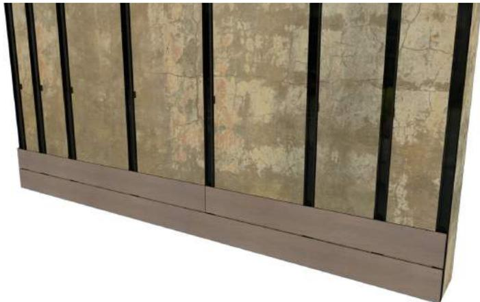
En la segunda fila de perfil Mont Blanc instalada, se aprecia que hay dos tablas. Estas dos tablas comparten el mismo clip, siendo la separación entre ellas de 5 mm.
