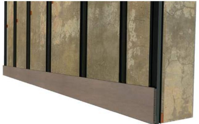
La parte superior de la tabla, la sujetamos con el clip de montaje rápido Mont Blanc. Este clip se inserta en el canal del rastrel con un simple giro y lo encajamos en ala de sujeción del perfil Mont Blanc hasta escuchar "click". Aunque el clip va provisto de agujero para alojar un tornillo, de momento, no será necesario atornillar, lo que reduce considerablemente el tiempo de montaje.
