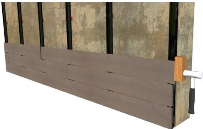
La junta de 5 mm entre tablas debe estar centrada con la vertical del agujero del clip. Esto es para que aseguremos que las testas de cada una de las tablas están perfectamente ancladas por el clip sin peligro de que pudieran perder el agarre debido a las normales dilataciones y contracciones que pueda sufrir el perfil por efecto de la temperatura.
