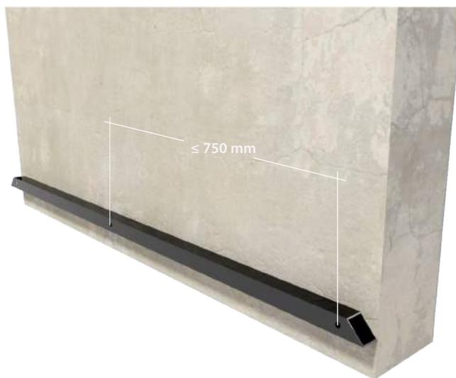
La fijación del marco se realizará con un elemento de fijación y el modo apropiado según el tipo de sustrato a instalar. Para soportes estables y buena consistencia, esta fijación se realizará en distintos puntos, con una separación entre puntos de fijación no superior a 750 mm.
