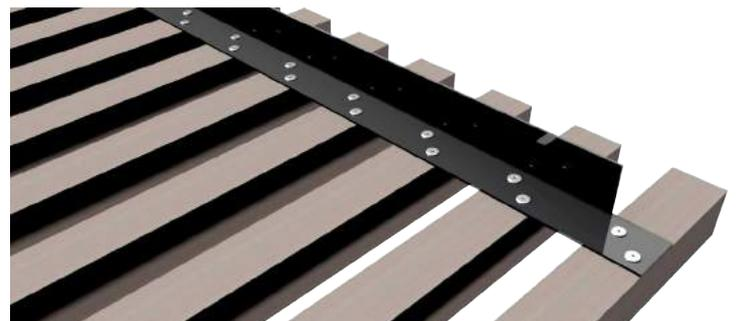
Realizados los agujeros, se fija cada uno de los perfiles Annapurna al ángulo mediante remaches. Los remaches deben ser de Ø4,8 x 16 mm de longitud. La cabeza del remache debe tener un diámetro mínimo de 14 mm. Esto es para facilitar las posibles dilataciones y contracciones que pueda tener el perfil por los cambios de temperatura y humedad.
